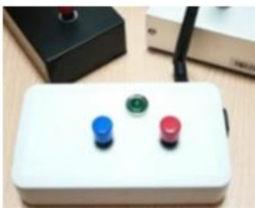
ワイヤレスリリースBOX。 親機と無線で繋がり 正解/不正解の判定が可能
