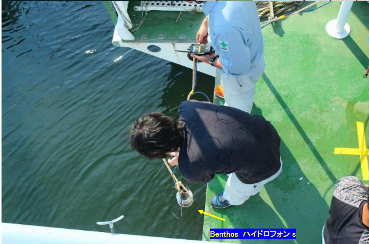
写真 1-2 GAPS(USBL)及び Benthos ハイドロフォンの艀装状況
