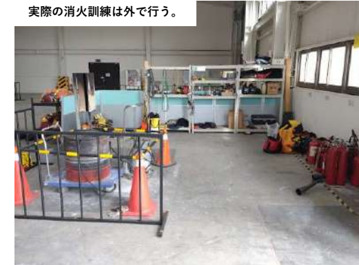
着火装置はプロパンガスを使用
