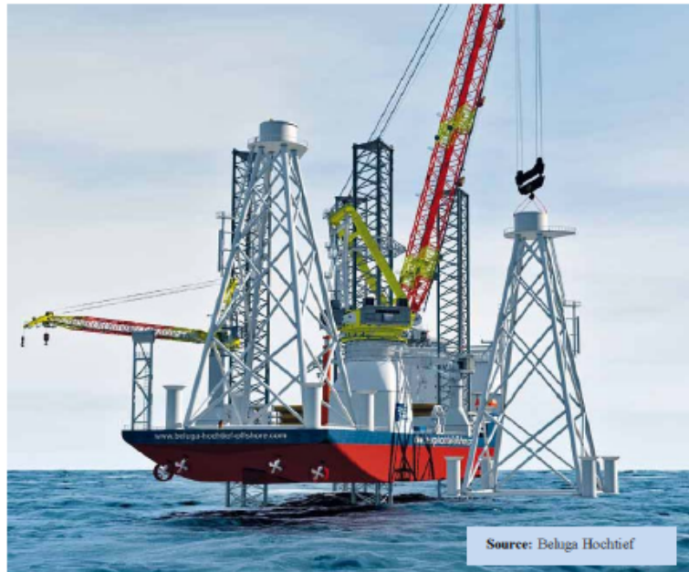
図表 5.18 Beluga Hochtief 洋上ウインドファーム設置作業船
