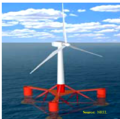
図表 2.8 オランダの Tri-Floater 概念
