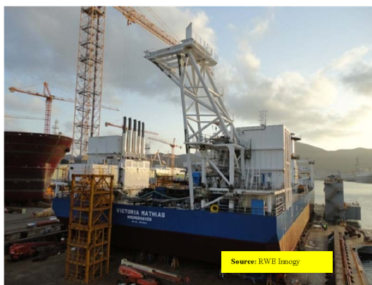
図表 5.17 RWE イノジー 洋上ウィンドファーム設置作業船
