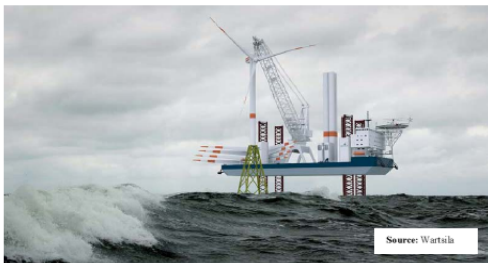
図表 5.15 Wartsila/Aker Solutions 洋上ウインドファーム設置作業船
