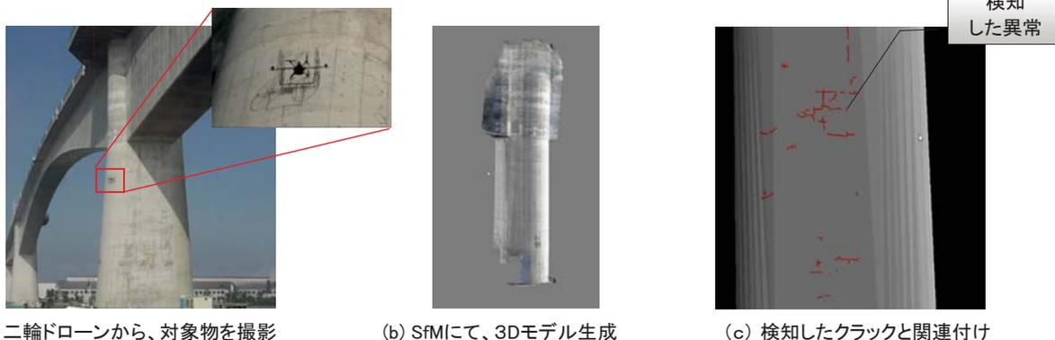
図2-1. ドローン搭載カメラによる3Dモデル生成
