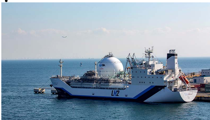
液化水素運搬船「すいそふろんていあ」と液化水素基地
