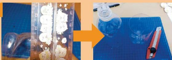
2ℓ ペットボトルを使います！下から 10.5cm 位のところに線を引き、カッターで切断します。
