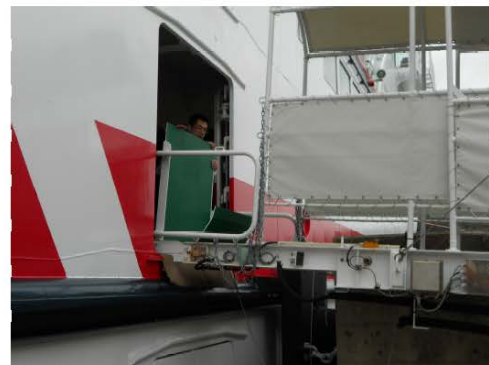
船舶の係員が船側スロープ板先端部を展開
