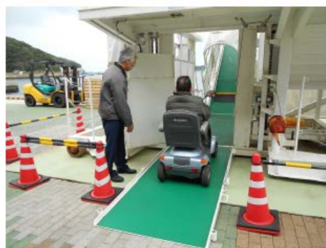
乗船の場合は、陸側スロープから昇降 装置に進入する
