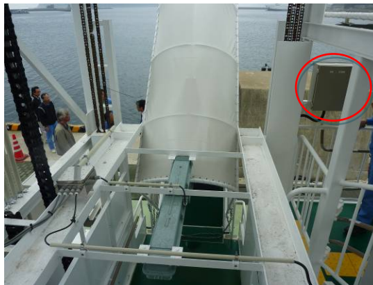
踊り場にあった操作盤A（赤丸）からは船側スロープ板の先端は見えにくかった
