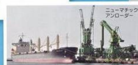
ばら積み船で運ばれてきた穀物は、ニューマ チックアンローダーという巨大な吸引機でペ ルトコンベアーに乗せられ、サイロへ向かう。
