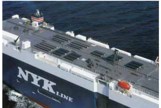
図2 15 太陽光エネルギーを利用した「アウリガ・リーダー」 (提供：日本郵船)
