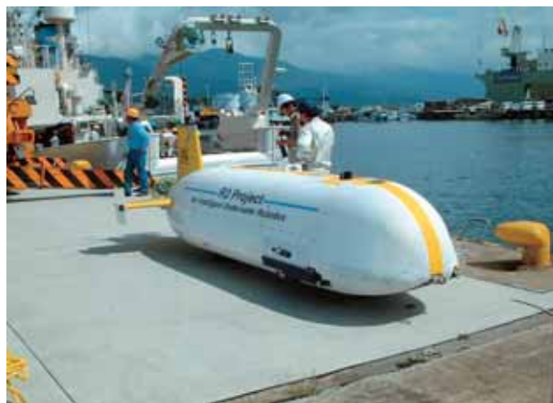
図5 1 2 東京大学生産技術研究所の浦教授が開発した4000 m級 AUV
