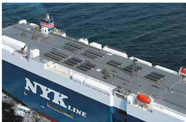
太陽光エネルギーを利用した「アウリガ・リーダー」 (提供：日本郵船)
