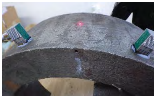
センサー 左:1MHz 70度 右:2MHz 70度
