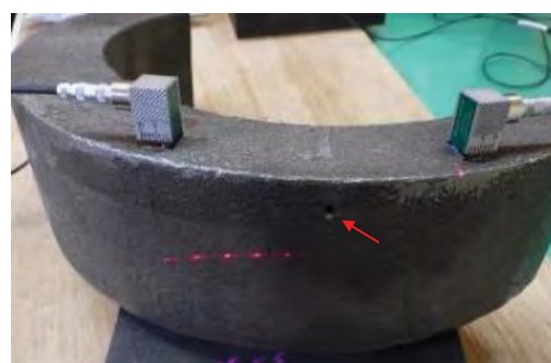
センサー 左:2MHz 70度 右:1MHz 70度
