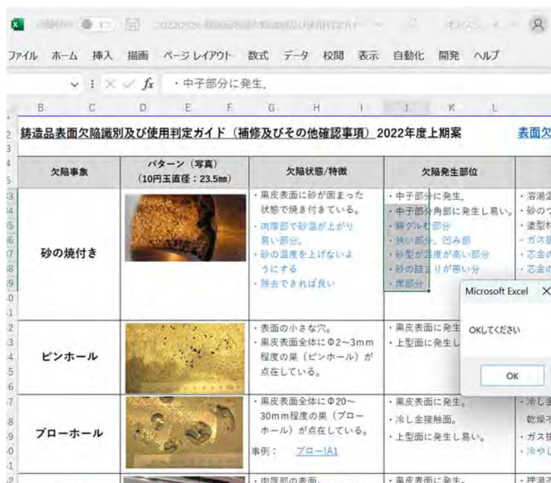
図 3.2-7 砂の焼付き (欠陥発生部位) をハイライト (シナリオ 1)
