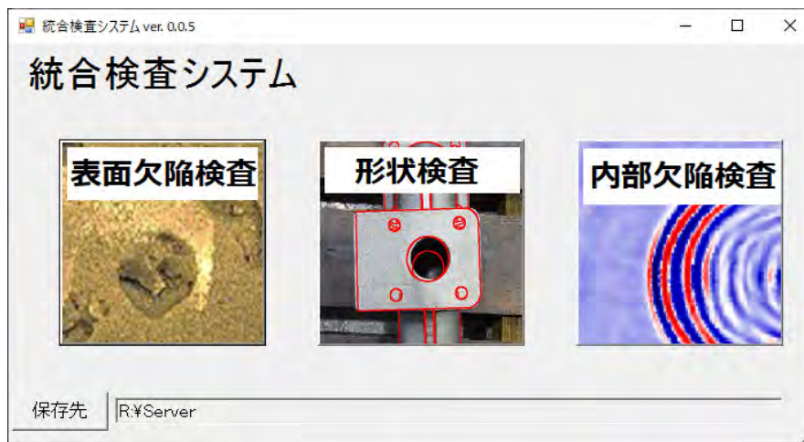
図 5.1-1 統合検査システムの起動画面
