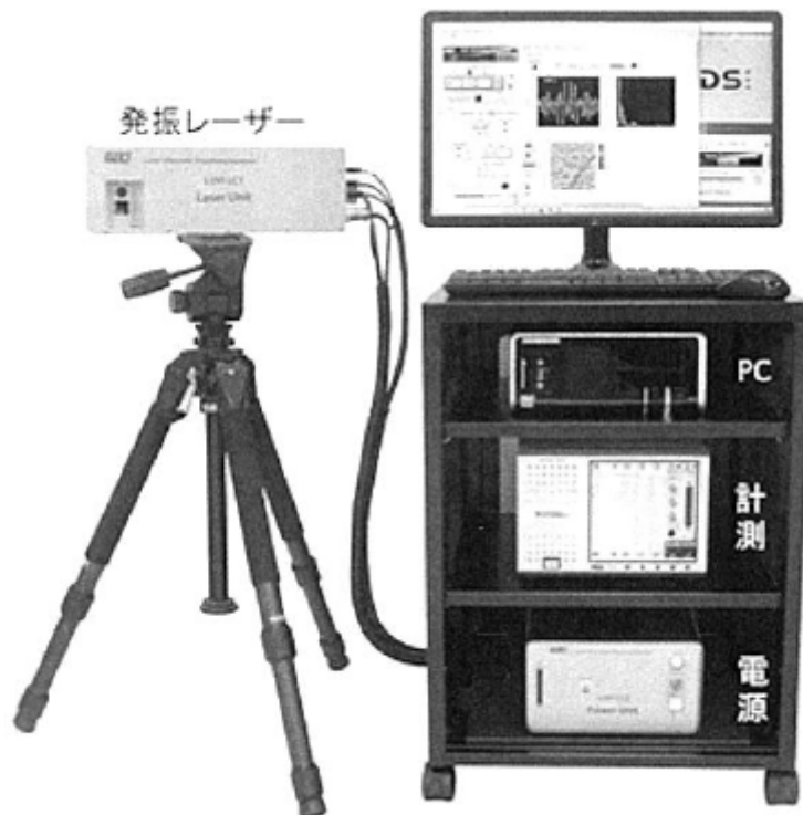
図 4. 1-2 レーザー超音波可視化システム外観 3)
