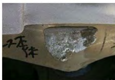
ブローホール⑧.JPG
