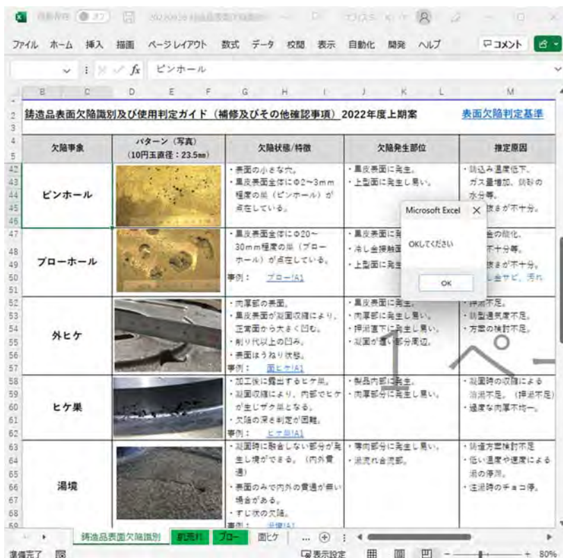
図 3.2-12 類似の欠陥事象 (ピンホール) がハイライト (シナリオ 2)
