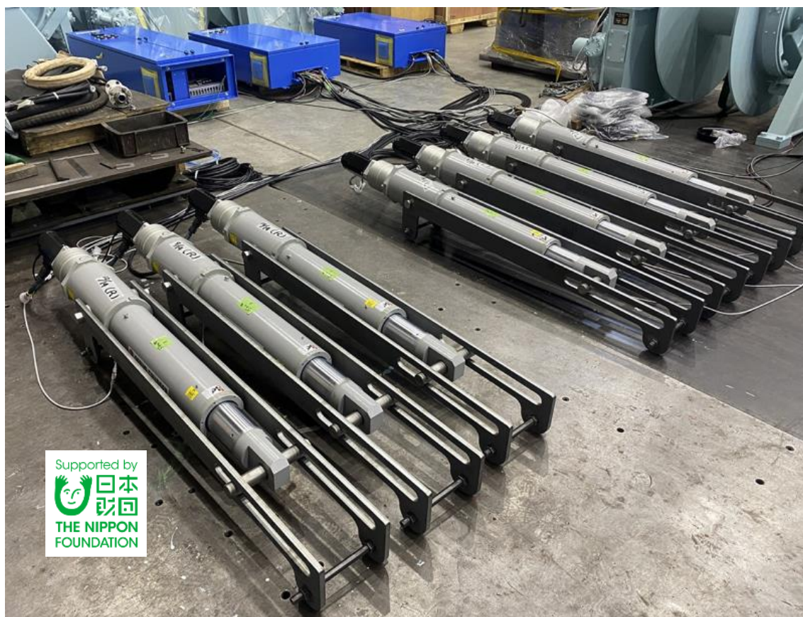
図16. 電動シリンダー仮配線
