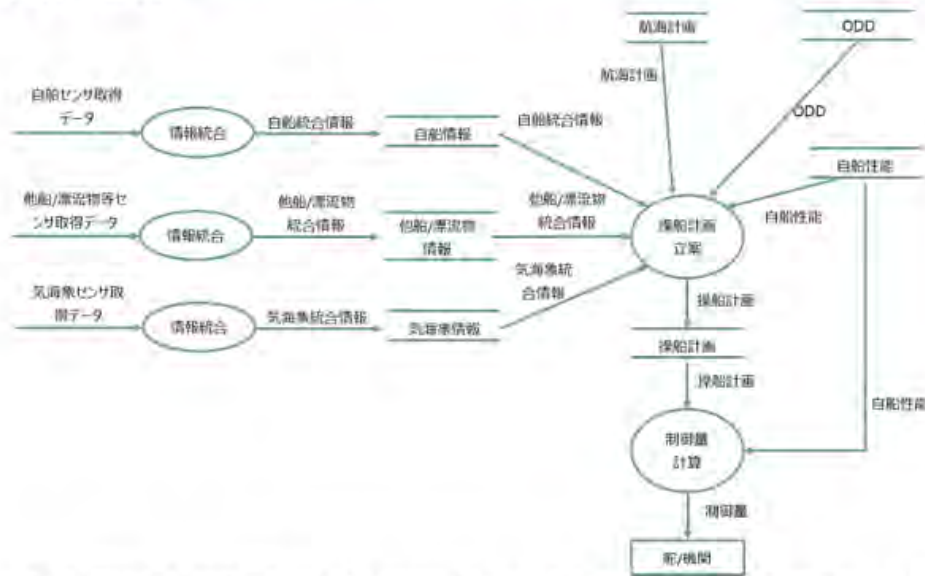
図 操船タイプ（RCC無しに船舶側で自律操船するタイプ）の操船に関する内部動作の概要
