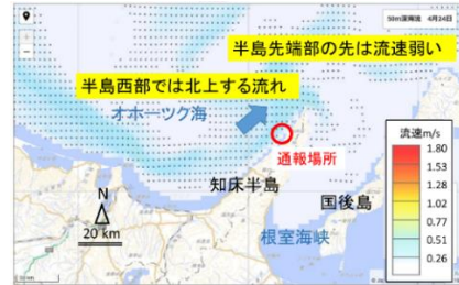
図-5 事故発生日の知床半島付近の海流の流向・流速分布注6) (2022年4月24日)
