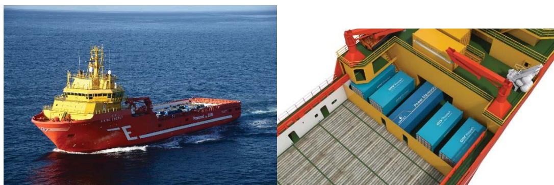
図 44：実証を行う Viking Energy 号とアンモニア燃料電池の搭載イメージ 209
