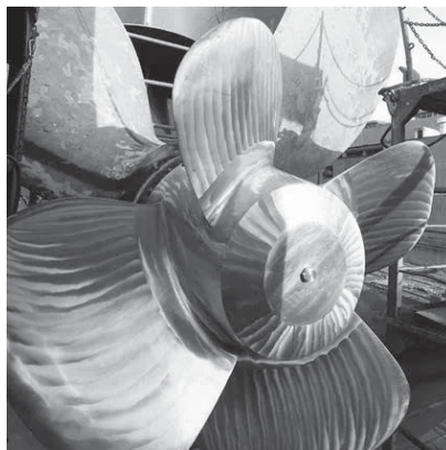
図 24 Wärtsilä 「EnergoProFin」 プロペラキャップ (出典: Wärtsilä)
