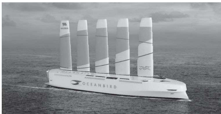
図 34 AlfaWall の風力支援推進システム「Oceanbird」 (出典: Alfa Laval)
