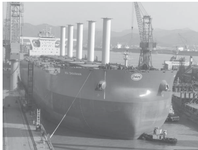
図 44 Norsepower ローターセイルを搭載した 325,000DWT 型鉱石運搬船 (出典: Vale)
