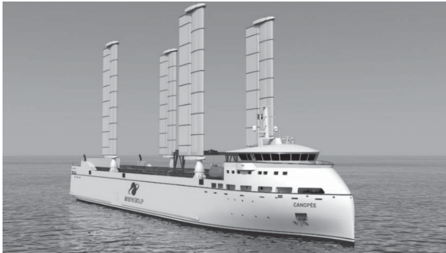
図 46 Oceanwings を搭載した「Canopée」
