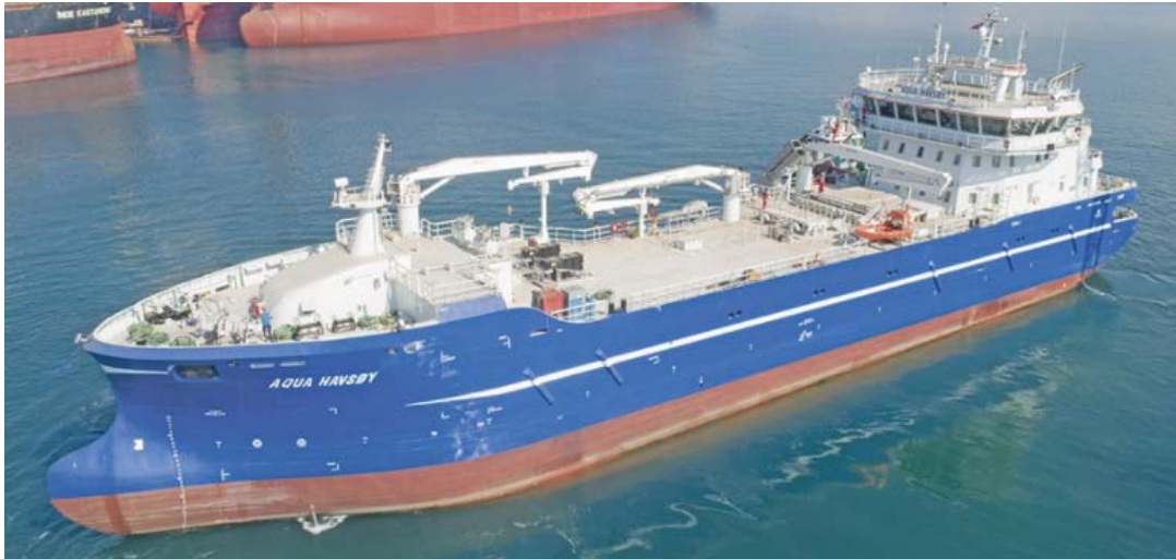
図 10 ノルウェーDESS Aquaculture Shipping 向け 3,900 m 3 型活魚運搬船「Aqua Havsøy」
