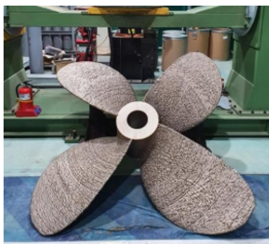
韓国生産技術研究がWire+Arc積層方式で製作した2mの大型船用プロペラ
