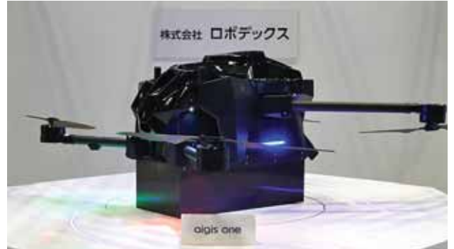
日本初の水素燃料電池専用のオリジナルモデル Aigis One (機体下部にはカーボンファイバー製の荷物BOXを備える)
