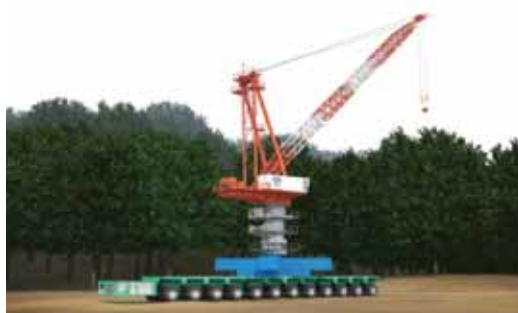
ドーリーで移動中
