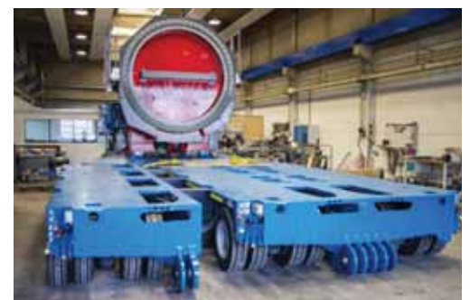
THP/SLスプリットモジュールを分割したテスト構成でのFTV 850 (写真: Goldhofer)
