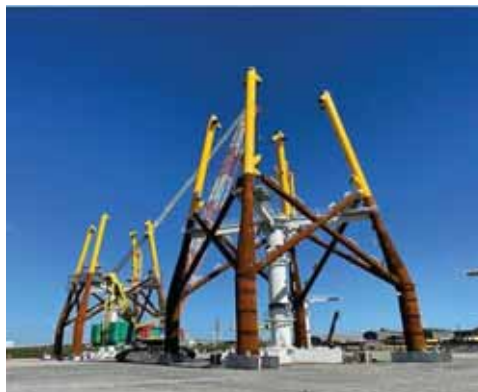
若松工場で作成しているジャケット式基礎
