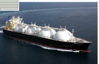
マイナス162℃に冷却し、液化した天然ガス (Liquefied Natural Gas = LNG) を専用の運送船をLNG船とします。
