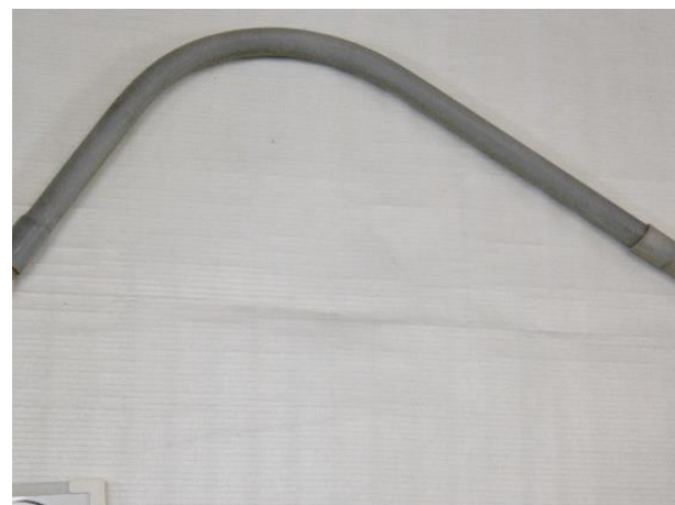
水道管・塩ビ管(PVC)
