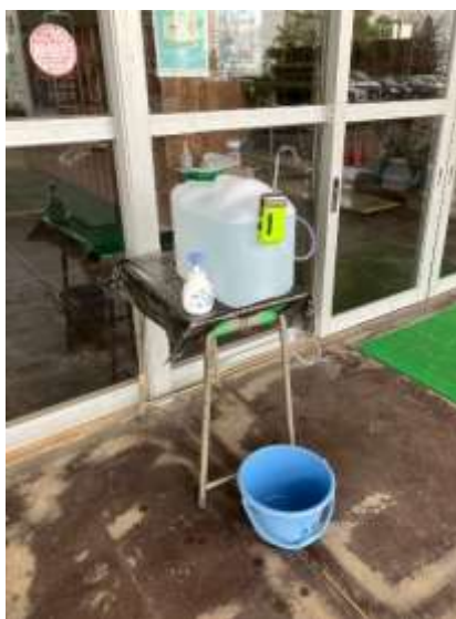
小木小学校に仮設したタッチレス水栓ポンプ
