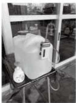
▲小木小に設置された水栓ポンプ
