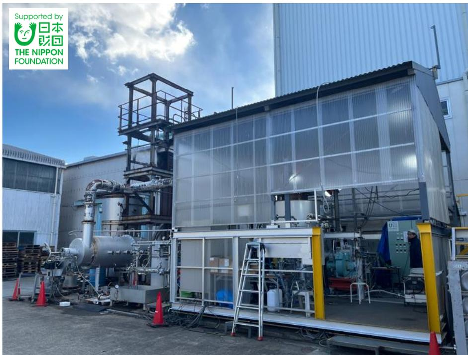
写真1 アンモニア燃料用ボイラ向けバーナ試作を設置した評価試験場
