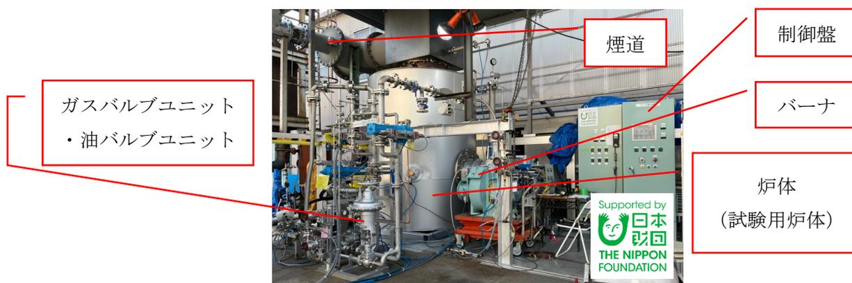
写真2 バーナ、炉体、ガスバルブユニット・油バルブユニット、煙道、制御盤の各試作
