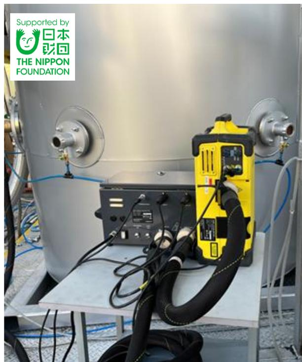
写真 6 排ガス測定するための計測器
