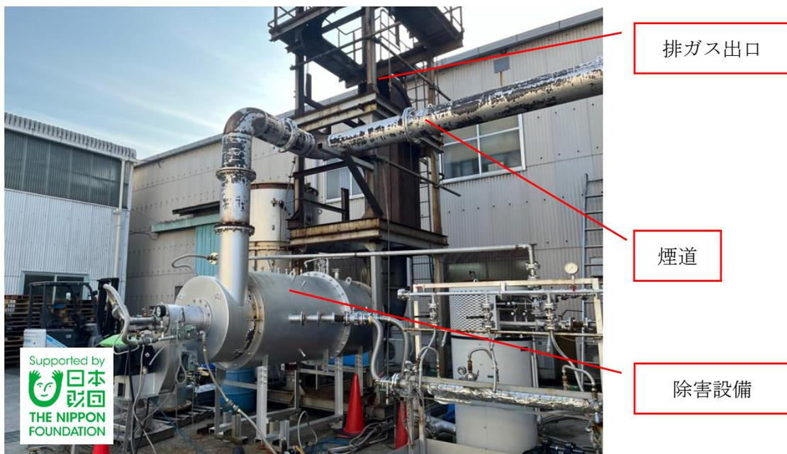
写真9 除害設備および排ガス出口（斜め右方向より）
