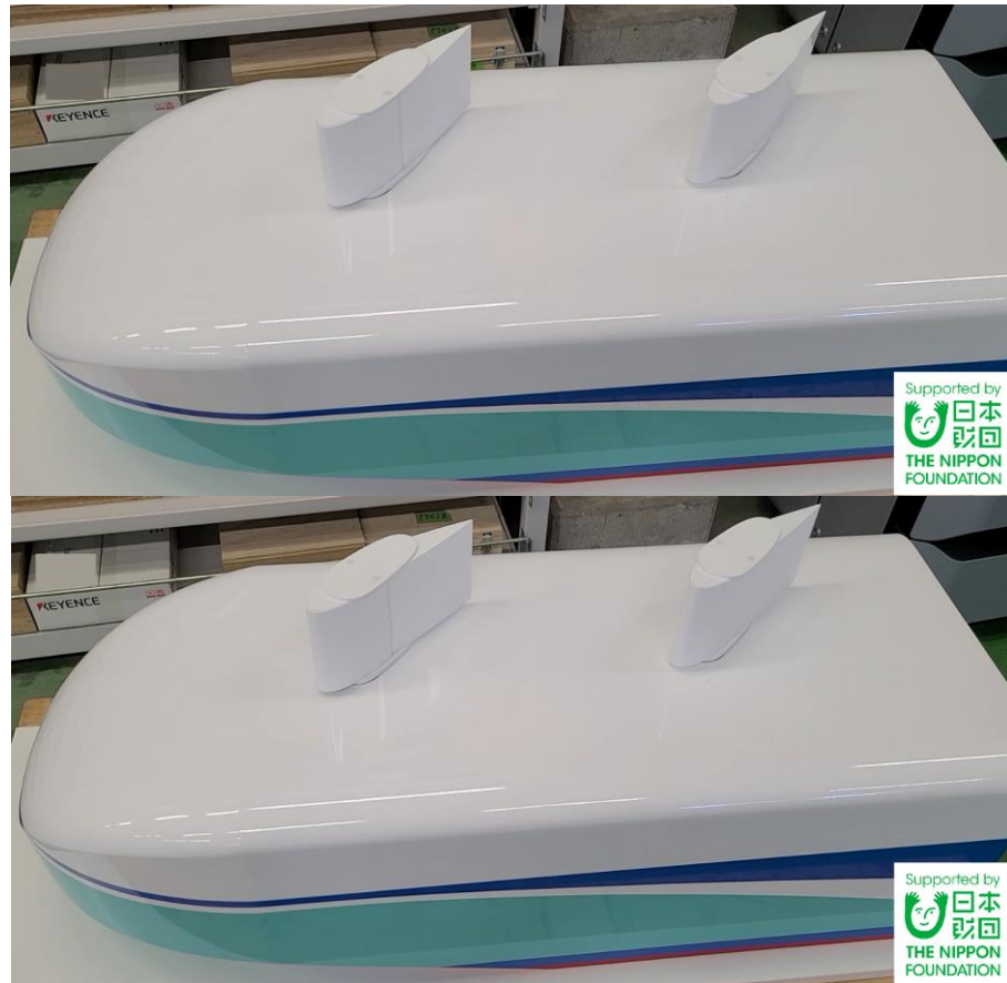
図 6.4.5 プロタイプモデル、帆の稼働イメージ (上：翼後半部キャンバーなし、下：翼後半部キャンバーあり)
