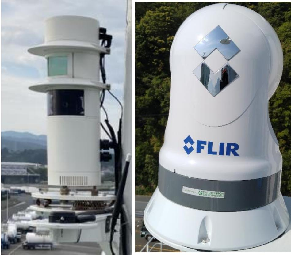
図 2 選定した画角／倍率固定カメラ外観（左）と PTZ カメラ外観（右）
