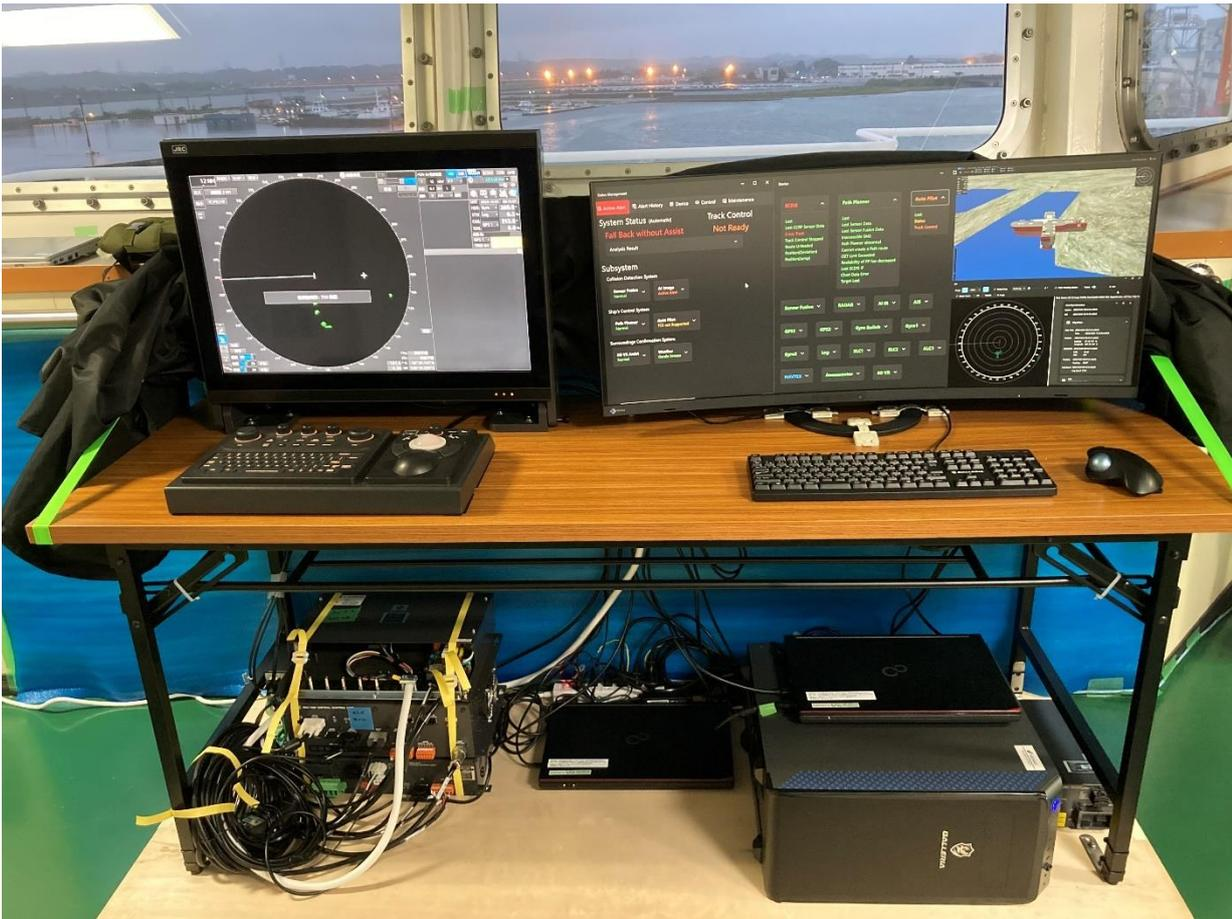
図 46 に示しているレーダー指示機(レーダー処理部/操作部/表示部)は本船の航海士の監視業務を妨げないため、本船の既存のレーダーとは別に準備したものである。本船のレ
