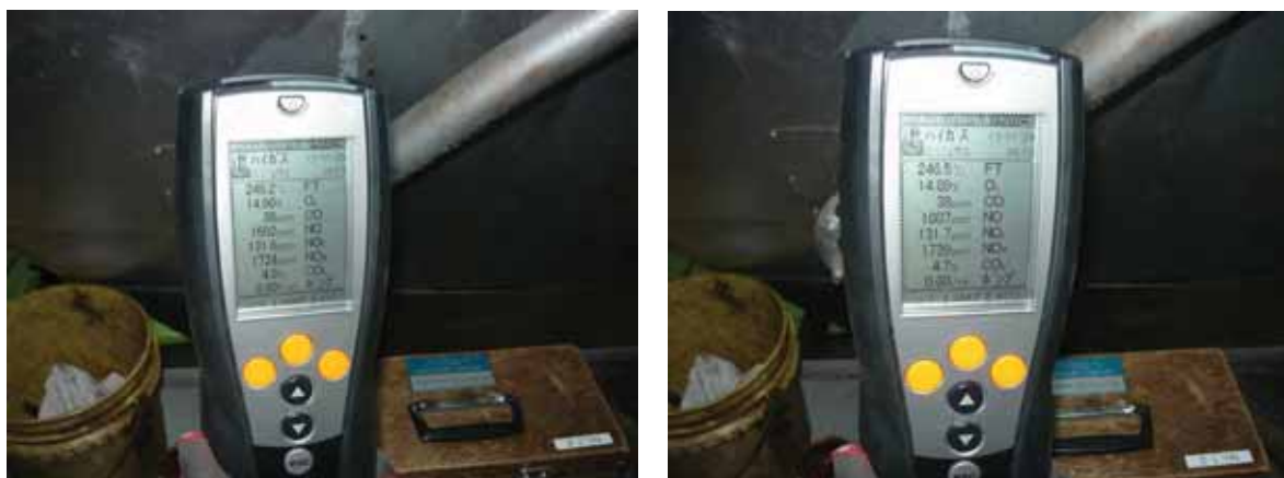
図 2.4-3 有害ガス濃度計測状況
