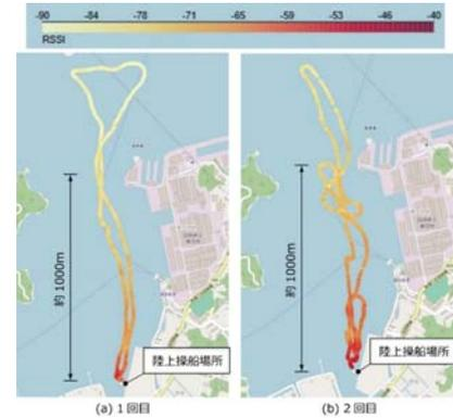
リピータ機能と高性能アンテナを用いた場合の電波強度RSSI
