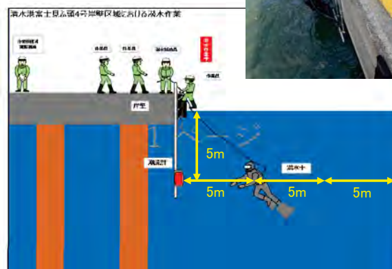
図3-14. 潮流計設置作業 (右上 : 潜水作業の様子)
