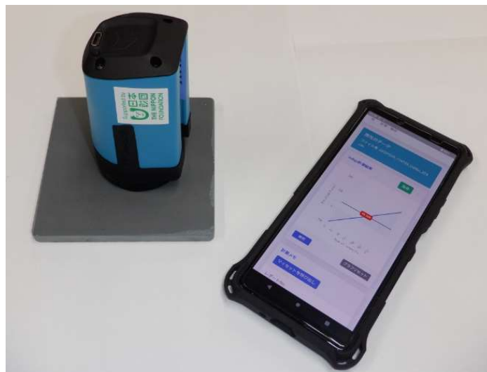
図 4.1.1 小型分光器”IndiGo”(左)とアプリ画面を開いたスマートフォン(右)
