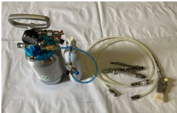
図 6 実用機（圧送装置）
