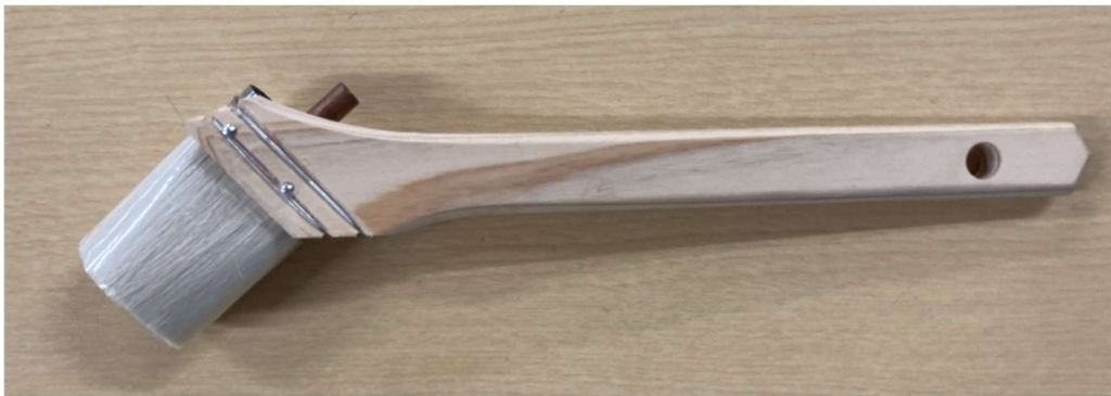
図4 木製グリップ固定式圧送刷毛
