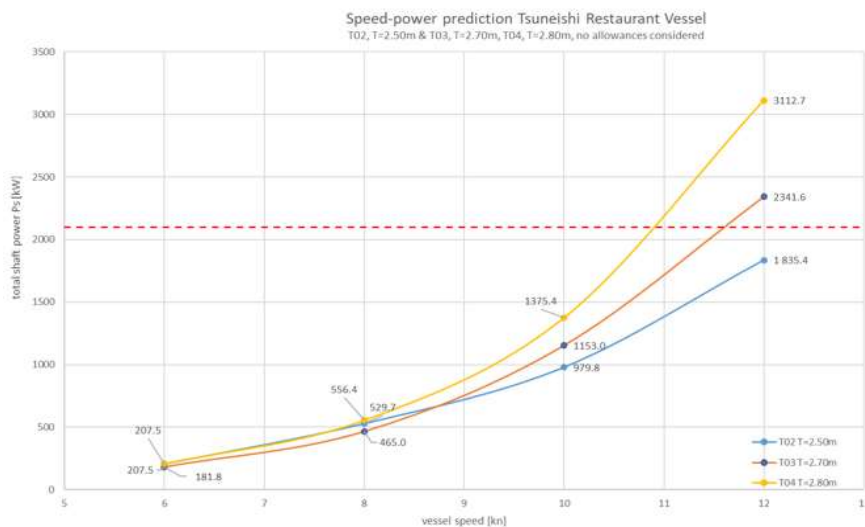
図4-(2)-2 シュナイダープロペラ装着状態でのスピードパワーカーブ比較
