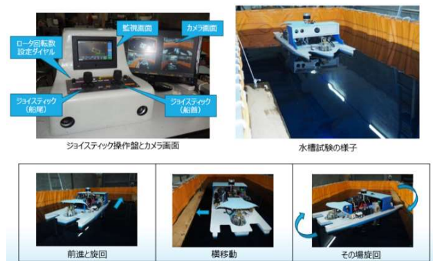
図4-(4)-3 ジョイスティックと模型船の動き
