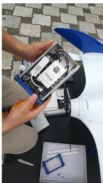
高出力通信モジュールへの交換
