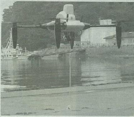
日本ドローン活用推進機構は川内町漁協と、ドローンを使ったナマコ密漁監視の実証実験を進める（写真上）。青森県産業技術センターが開発する着水型ドローン。吊り下げた水温計で、水中のデータを収集する
