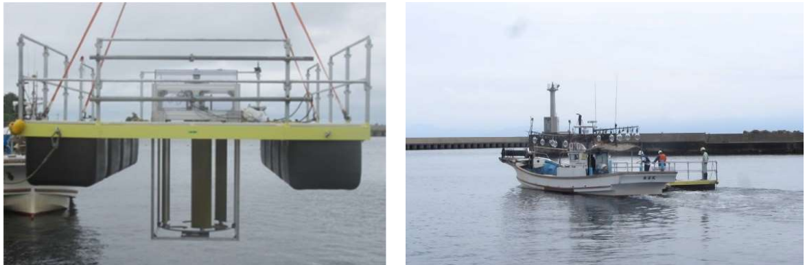
図7 垂直軸型可変ピッチ翼水車の曳航試験
