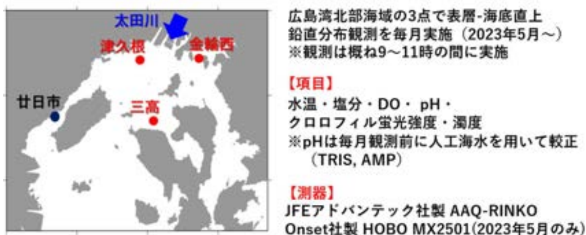
図 C-6. 広島市農林水産振興センターによる水質鉛直分布観測の概要
