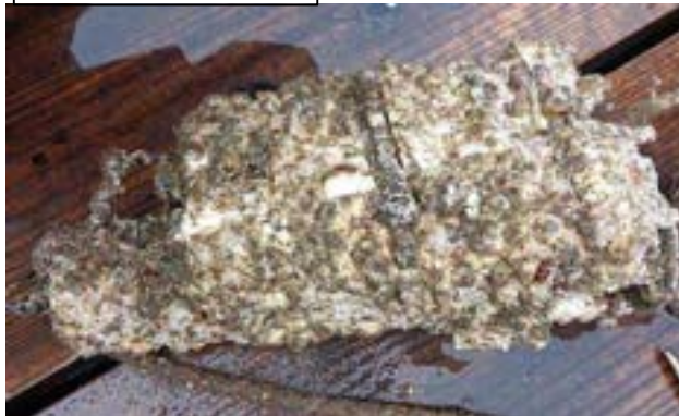
図 C-2. 観測センサーへの生物付着状況
