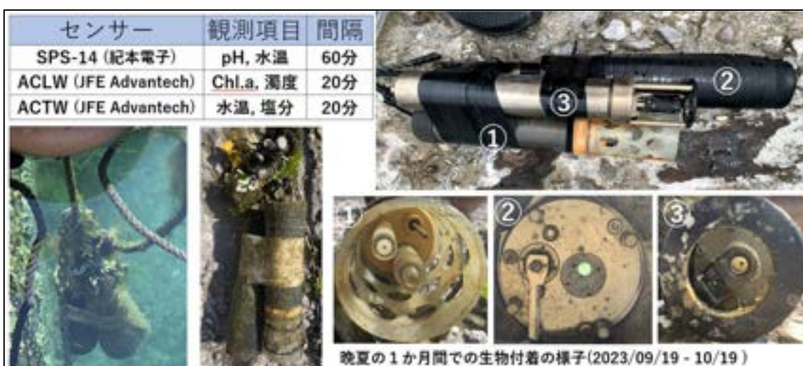
図 D-3. 観測方法および観測機器の保守管理の状況(付着生物防除のために銅板設置)
