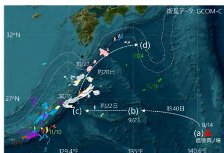
「しきさい」搭載の多波長光学放射計 SGLI の近赤外等から推定された8月～11月の海面を漂流する軽石の移動の様子 (<https://earth.jaxa.jp/karuishi/>)。8月中旬に図中の赤三角で示す福徳岡ノ場海底火山の周辺(a)で確認され、40日後には北西方向(b)に移動し、さらに約22日後に沖縄周辺(c)に移動している様子が確認された。その後、周辺海域との反射率の違いが次第に小さくなり黒潮周辺(d)で確認された以降は識別できなくなった。
