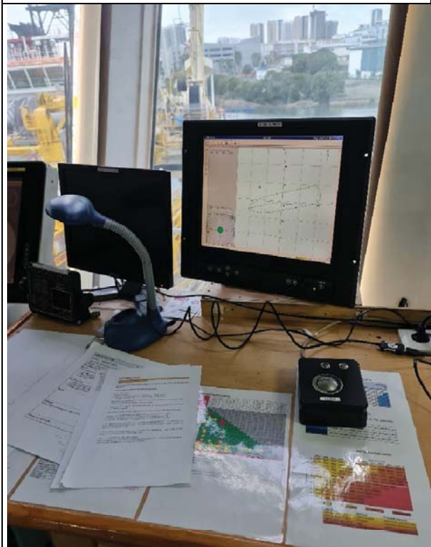
船位保持システム・レファレンス HIPAP 使用コントロール
