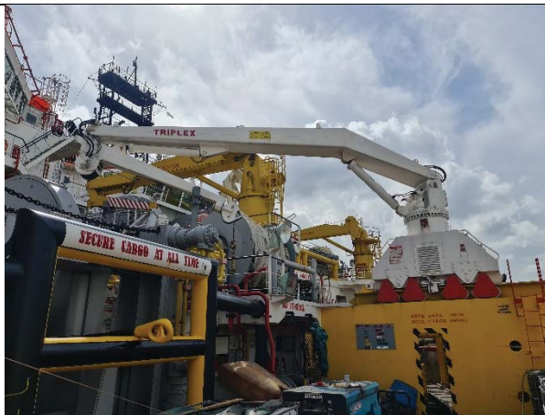
4.5T／13m カーゴレール移動クレーン
