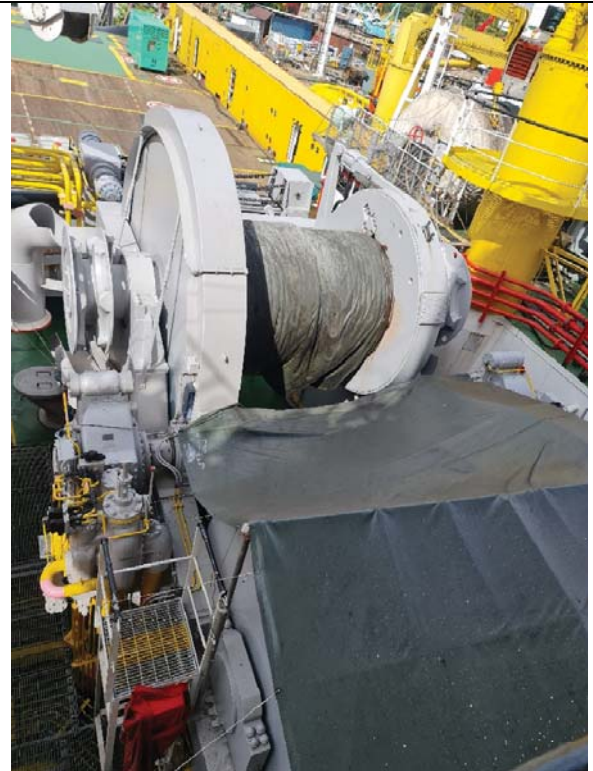
ダブルドラム・ウォーターフォール型・アンカーハンドリング／トローイング・ウインチ
