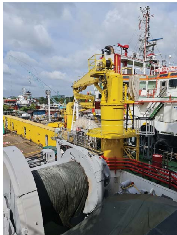
5T/14m使用プロビジョン・クレーン
