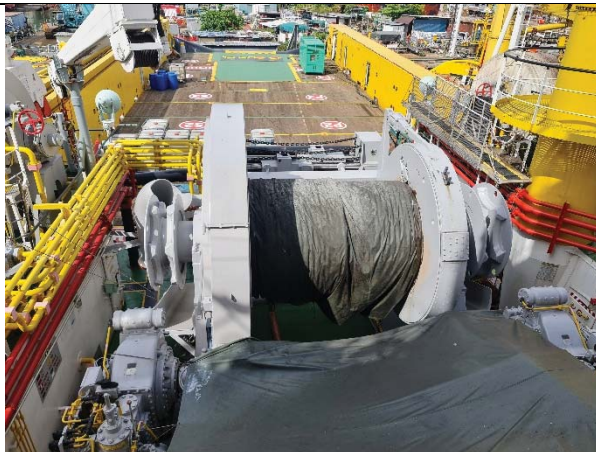
ダブルドラム・ウォーターフォール型・アンカーハンドリング／トローイング・ウインチ
