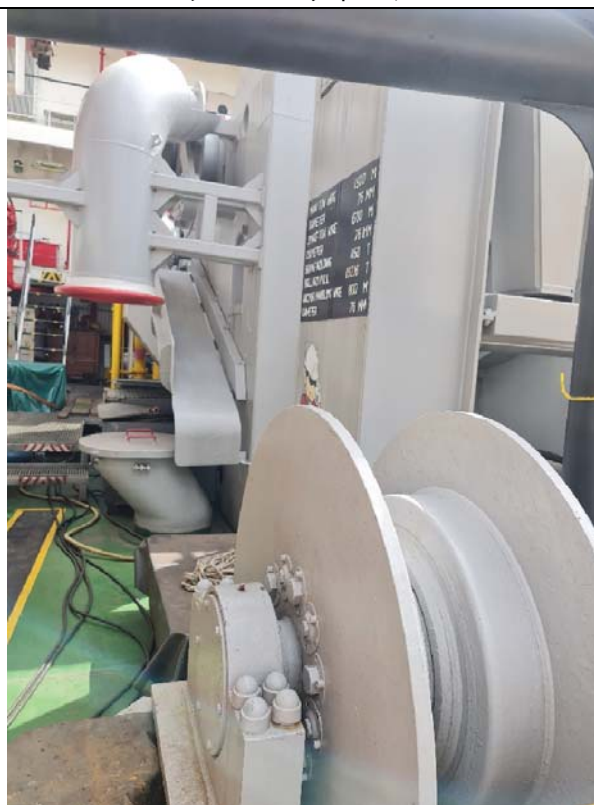
アンカー・ハンドリング用 アンカー・チェーン・ガイド
