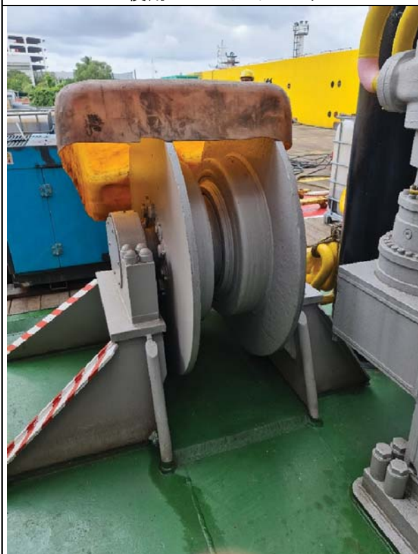
アンカー・ハンドリング用 アンカー・チェーン・ジブシー
