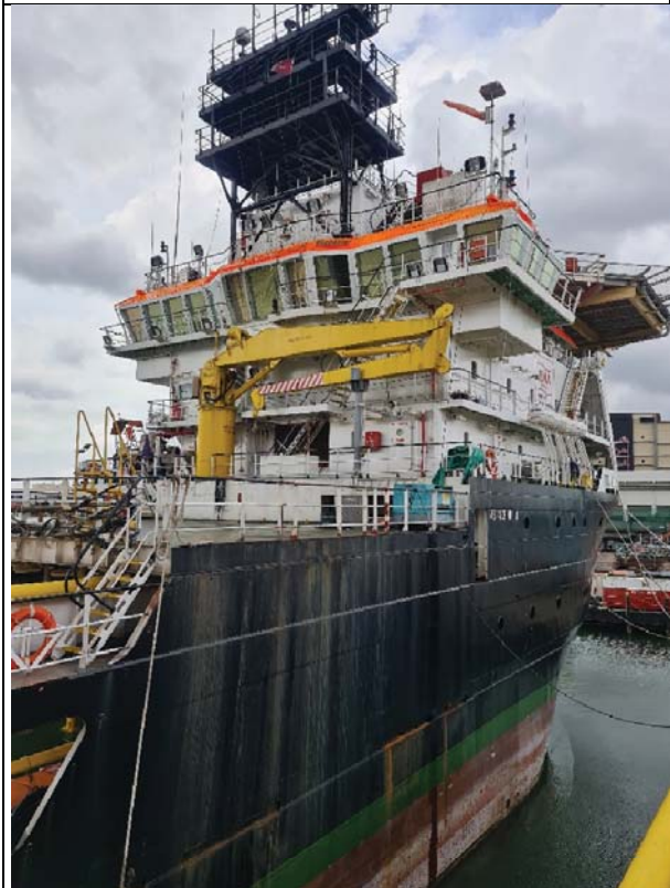
5T/15m使用プロビジョン・クレーン
