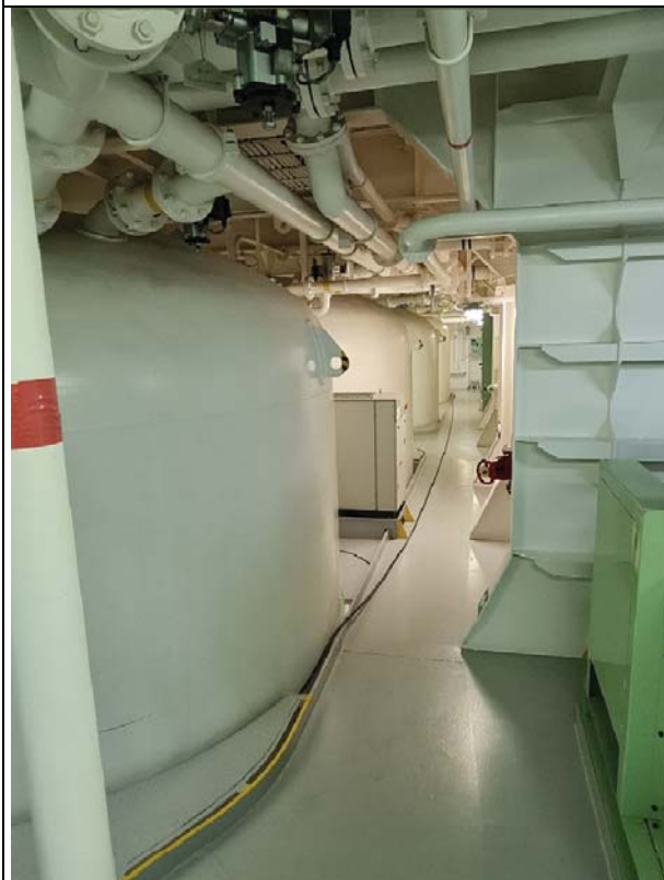
ドライ・バルク・タンク「セメント、 バライト、ベントナイト使用タンク」
