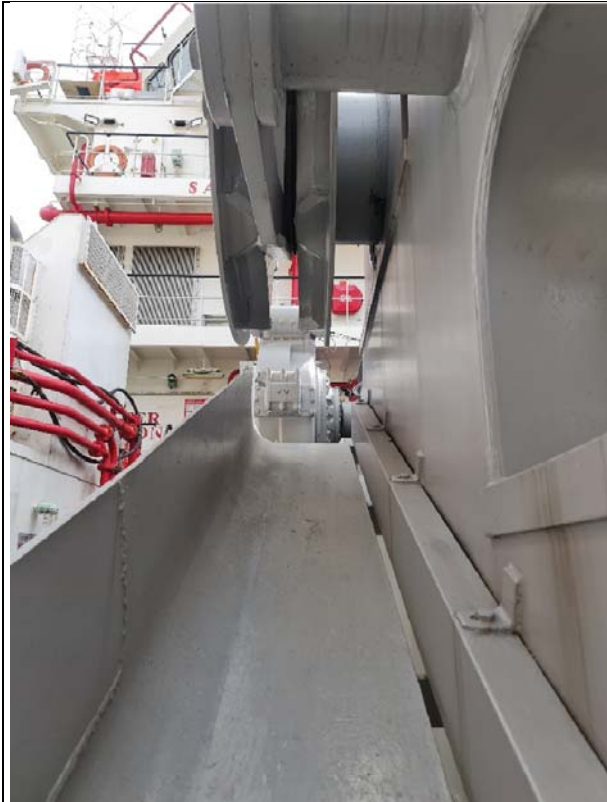
アンカー・ハンドリング用 アンカー・チェーン・ガイド
