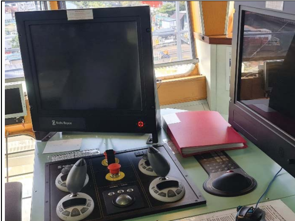
アンカー・ハンドリング・トーイング・ウインチ・コントローラ
