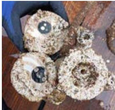
図 C-2. 観測センサーへの生物付着状況
