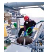
従来の「手動」によるタンクの洗浄作業
