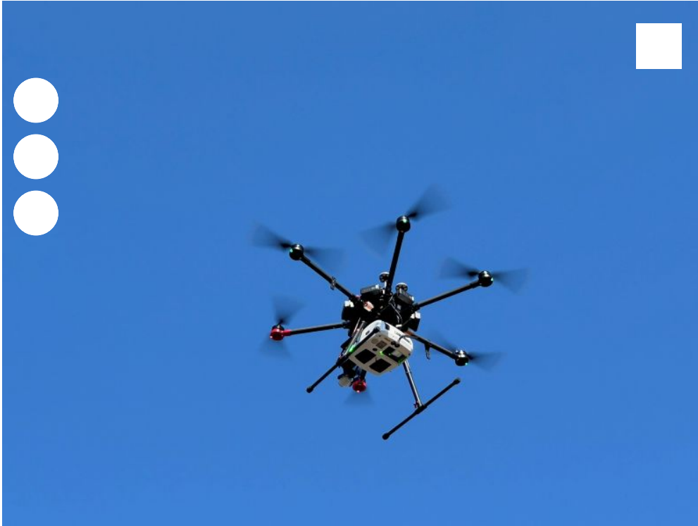
ドローンの下部からグリーンレーザーが照射される
