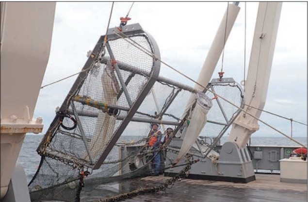
4 mビームトロールによる海溝からの底生動物採集
