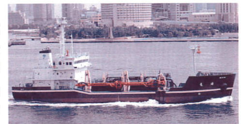
▲海底の土砂をさらう「しゅんせつ船」
