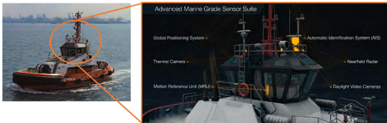
図 23 インテリタグ船のセンサーフュージョン
