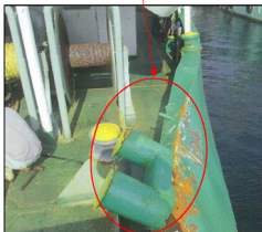
B船の損傷状況(右舷船尾部外板)
