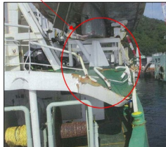
B船の損傷状況(右舷船尾部甲板及びハンドレール)
