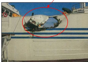
B船の損傷状況(右舷船尾部甲板及びハンドレール)
