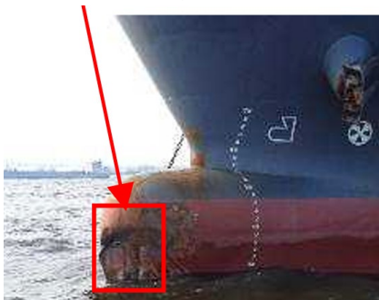
球状船首部の亀裂
