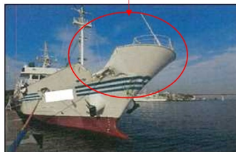
A船の損傷状況 (右舷船橋付近外板)
