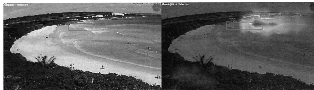
Fig. 6 AIモデルの判断根拠の可視化；AI検知結果とGrad-CAMオーバーレイの比較
