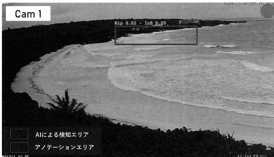
Fig. 7 AIモデルによる離岸流検知の検証結果の例（アノテーションエリアとAI検知エリアの比較）
