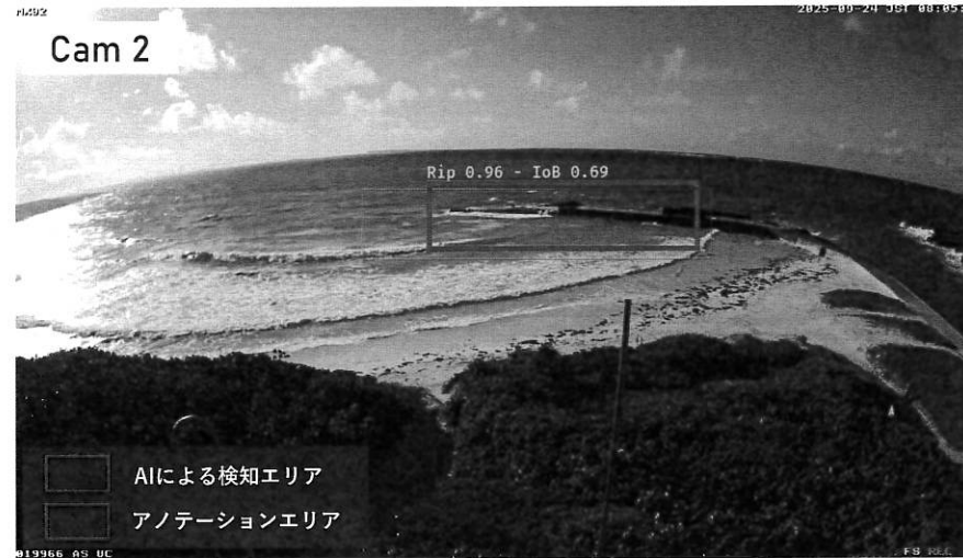
Fig. 7 AIモデルによる離岸流検知の検証結果の例（アノテーションエリアとAI検知エリアの比較）
