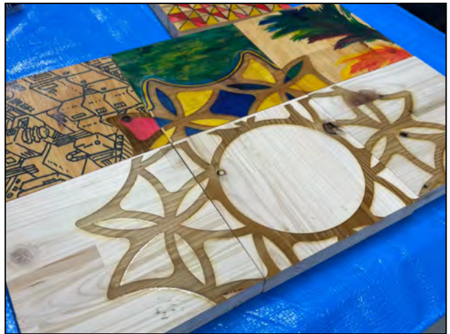
fig2. レーザーカッターでKASEIロゴを刻印
