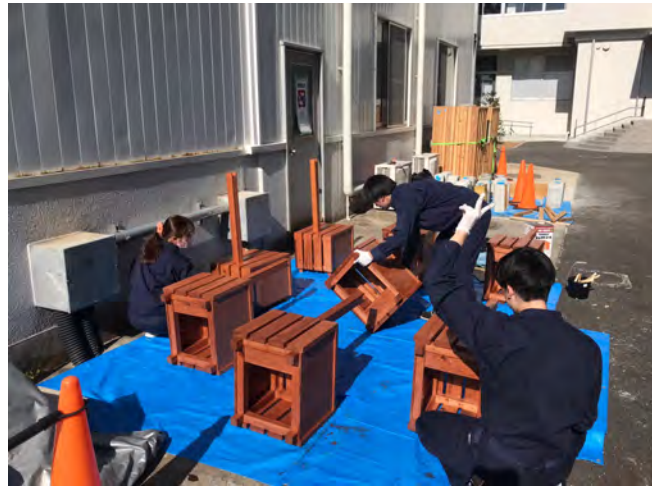
fig2.有志学生による防腐剤塗布の様子
