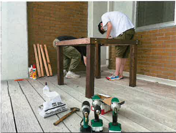
ネジ穴をダボで埋めて見栄えを良くする
