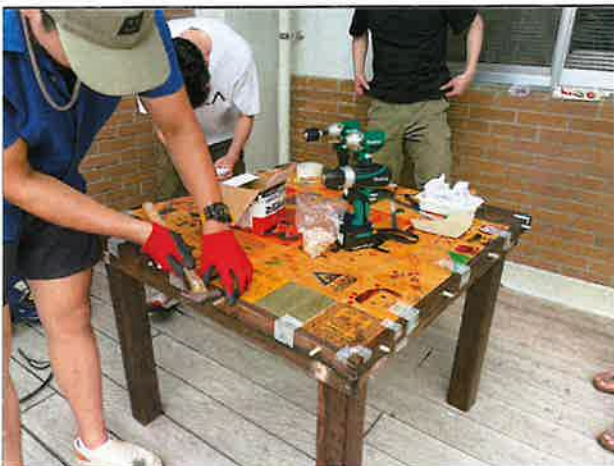
天板と脚等を固定後、ダボ、パテなどで小さな歪みなどを修正
