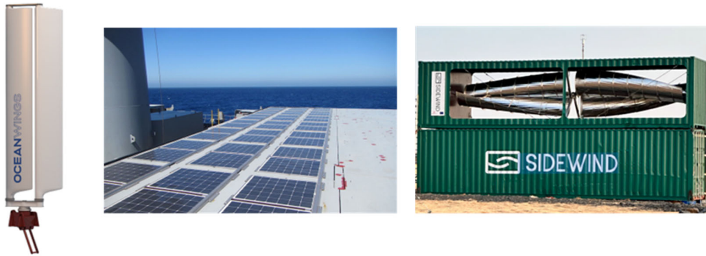
図 23 風力支援推進システム（左）、太陽光・風力による発電システム（中央・右）
