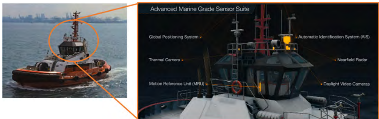
図 54 インテリタグ船のセンサーフュージョン
